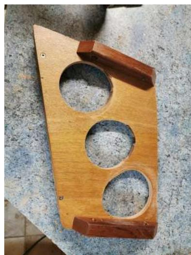
On démonte le bord en tissu puis on perce 3 trous de 9cm de diamètre. On élargit ces trous dans le sens de la profondeur de l'étagère afin de pouvoir faire passer les bouteilles facilement.
